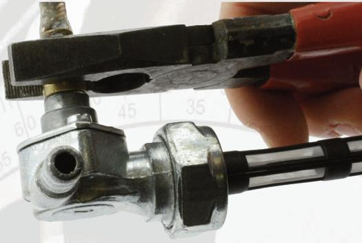
**Wichtiger Hinweis:** Bitte beachten Sie vor der Montage des Benzinahnes, dass Sie diesen mit Hilfe einer Kombizange die direkt an der Messinghülse am Benzinahn angesetzt wird (siehe Bild) erst gangbar gemacht werden muss. Dieses erreichen Sie durch eine  $\frac{1}{4}$  Drehung nach rechts und eine  $\frac{1}{4}$  Drehung wieder nach links.
