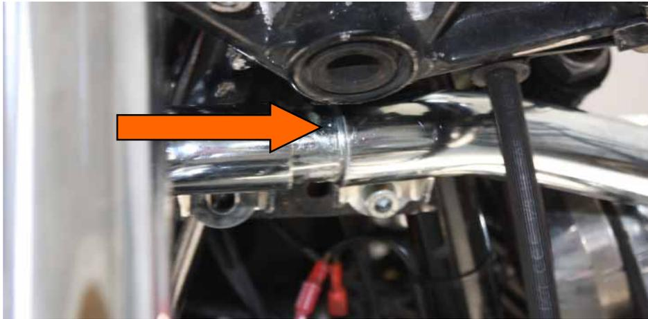
4. Mit einem Gummihammer / Schonhammer den rechten Bügel mit vorsichtigen Schlägen in Position bringen, bis die Schraube eingeführt werden kann.
