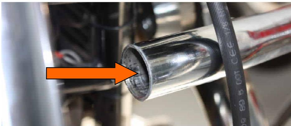
3. Anschließend den zweiten Sturzbügel (Fahrtrichtung rechts) soweit es geht mit den Händen rein schieben.
