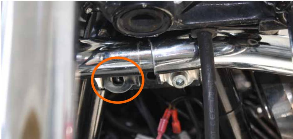
5. Zum Schluss alle Schrauben festziehen und überschüssiges Schmierfett abwischen.
