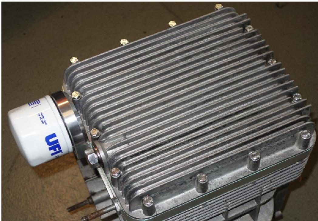
Das wars im großen und ganzen, jetzt wird das Ölpumpenzahnrad wieder auf der Ölpumpe befestigt, der Stirndeckel wird mit neuer Dichtung angeschraubt. Die vordere Motorsteckachse kommt wieder rein und wird mit dem Rahmen verschraubt. Die Ölablaßschraube wird wieder mit neuem Dichtring festgezogen.
