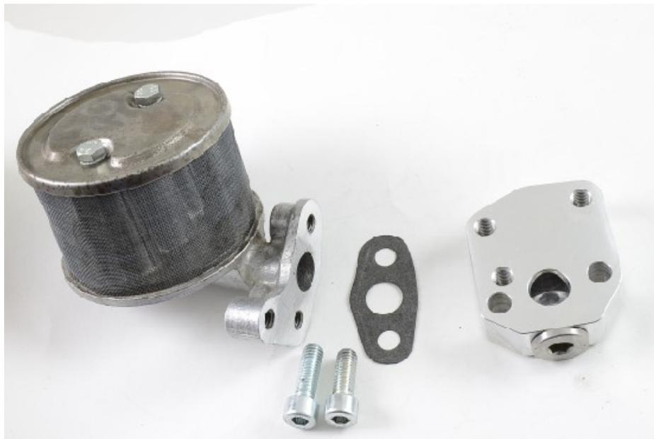
Das Saugrohr wird jetzt mit dem Adapter und der Dichtung fest verschraubt, bitte die beiliegende Dichtung und die beiden M8 x 22 Innensechskantschrauben verwenden. Das sollte dann so aussehen:
