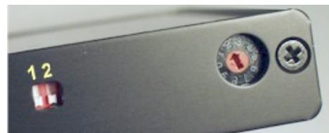
Abbildung 5 DIP-Schalter und Drehschalter.
