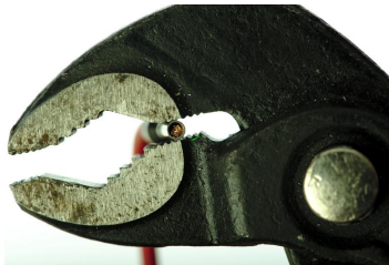
Crimpen mit einer Wasserpumpenzange.
