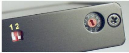
Figure 2 DIP-Schalter und Drehschalter.
