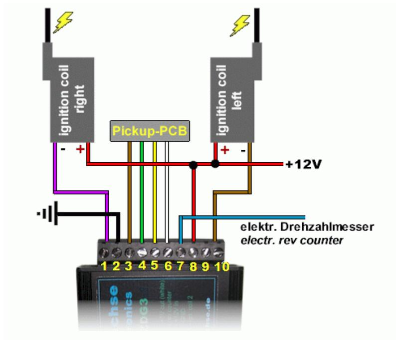
Anschlussschema der Zündung bei Motoplat-Ersatz
