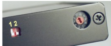
Abbildung 4 DIP-Schalter und Drehschalter.
