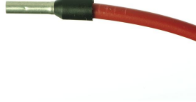
Die Aderendhülse wird soweit es geht auf das Kabel aufgeschoben.
