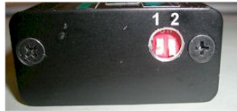
Abbildung 3 DIP-Schalter und Zündkurvenauswahl.
