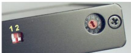
Figure 1 DIP-Schalter und Drehschalter.
