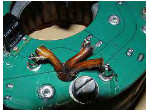
Abbildung 3 Anlöten der 3 Statorphasen
