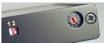
Figure 2 DIP-Schalter und Drehschalter.
