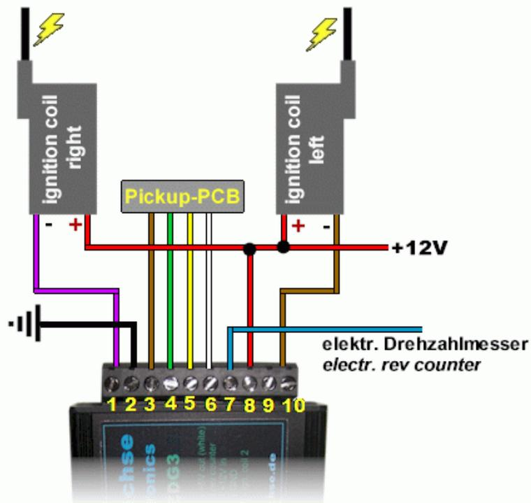
Anschlusschema der Zündung mit den zwei Originalzündspulen
