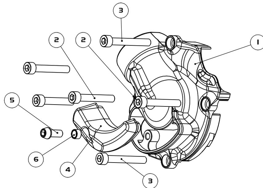
Per fissare il PRO-0813 alla moto servono solo 4 delle 6 viti fornite.
