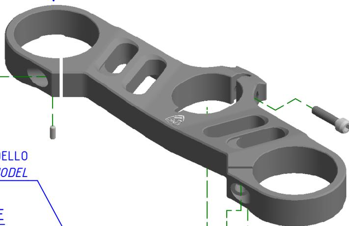
INSERIRE NEL FORO CORRETTO A SECONDA DEL MODELLO
