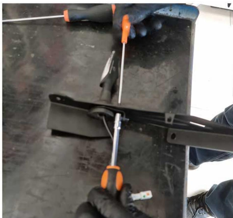
***Inserire le frecce aiutandosi con un pò di WD40 o similare ed utilizzare le forchettine F per completare il fissaggio.***
