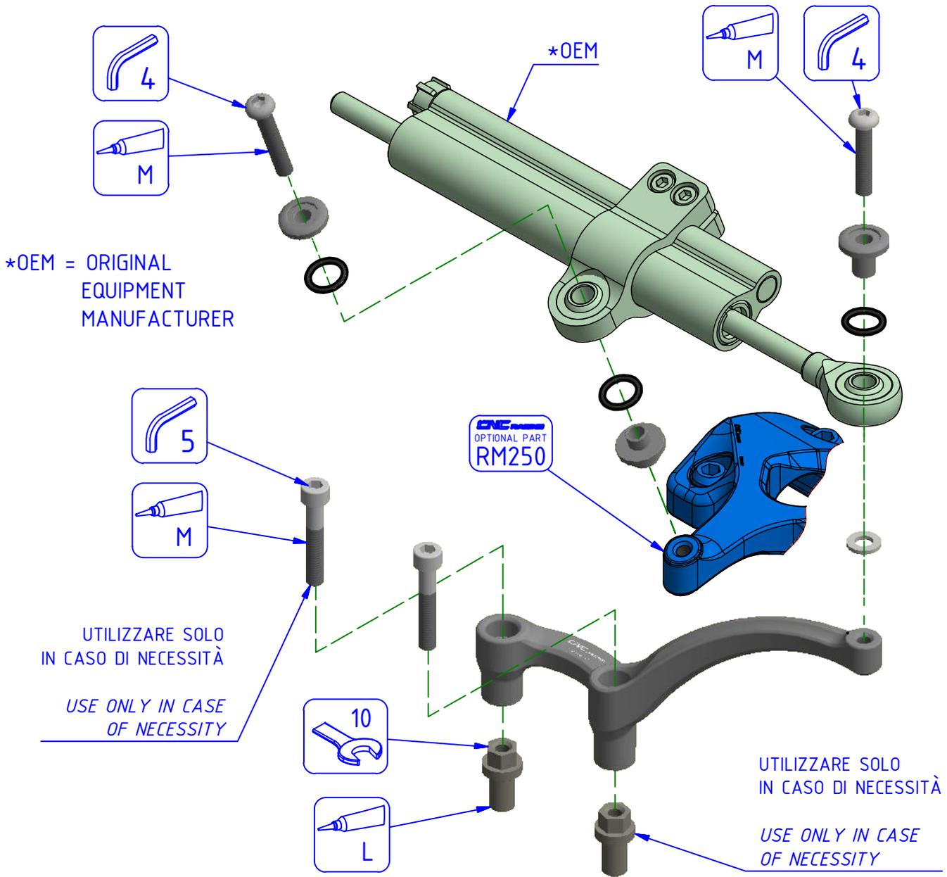
NEL CASO DI MONTAGGIO CON AMMORTIZZATORE DI STERZO ORIGINALE MONSTER 1200R USARE SOLO IL PARTICOLARE 1 DELL'ELENCO PARTI
