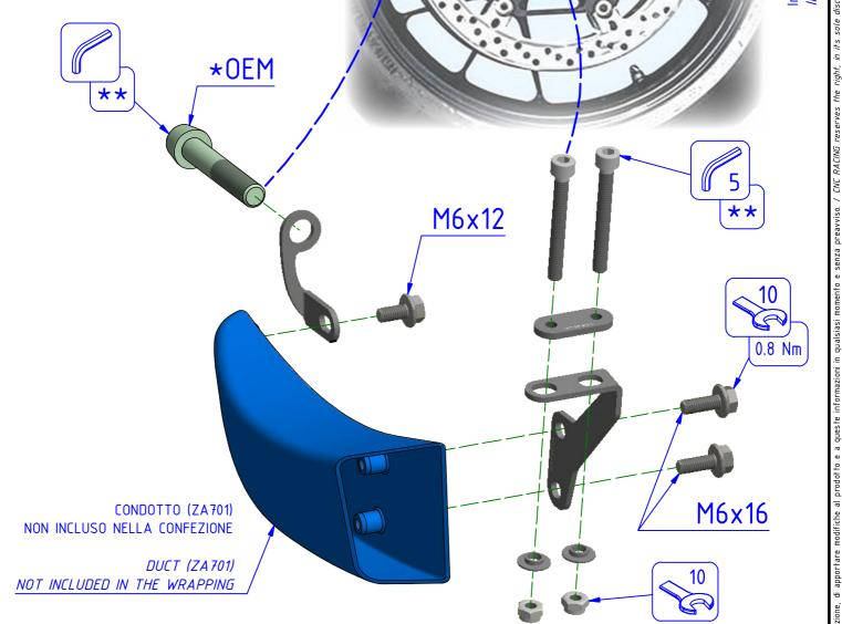
\*\* PER IL SERRAGGIO DELLE VITI RIFARSI AL MANUALE DEL COSTRUTTORE
