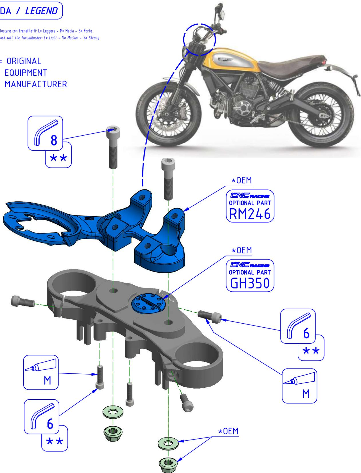
\*\* PER IL SERRAGGIO DELLE VITI RIFARSI AL MANUALE DEL COSTRUTTORE
