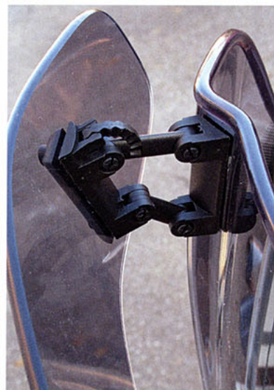
Beweglich und dennoch stabil: die Mechanik für den Vario-Spoiler
