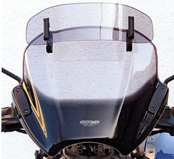
Speed-Screen plus Spoiler gleich Vario-Touring-Screen. Beide Teile können individuell ausgerichtet werden
