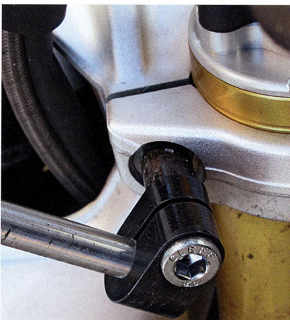
Universal-Lösung: Anschraubpunkte an der Klemmung der oberen Gabelbrücke – das passt bei fast allen Unverkleideten
