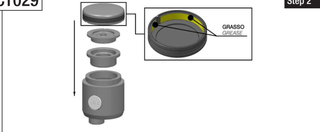
**ITA** △ – Prima di rimontare il tappo pulire da qualsiasi contaminante le guarnizioni, il serbatoio e il tappo.
