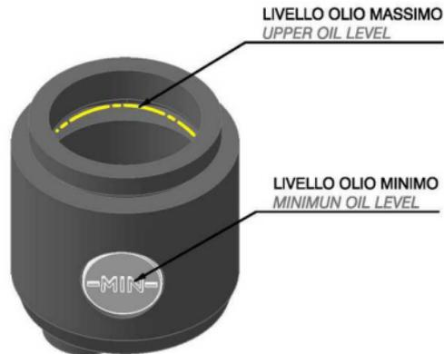
**ITA** △ – Dopo il primo riempimento controllare periodicamente il livello dell'olio. Un eccessivo livello può creare delle fuoriuscite di liquido, al contrario un livello insufficiente può creare inefficienze al sistema.
