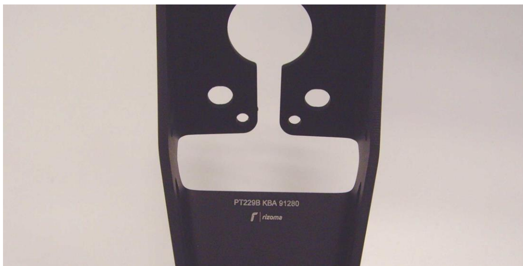
Kennzeichnung, Beispiel Herstellerlogo rizoma, Typ PT, Ausführung 228, Farbcode B (schwarz), Typzeichen KBA 91280
