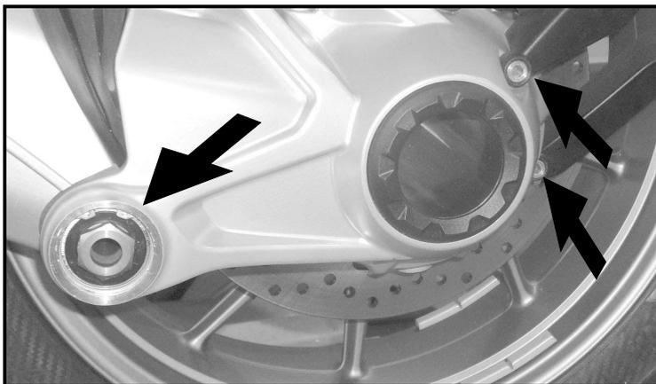
Montage des Kardanschutzes vorne:
