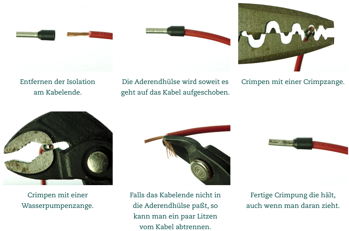
Abbildung 1 Crimpen der Aderendhülsen
