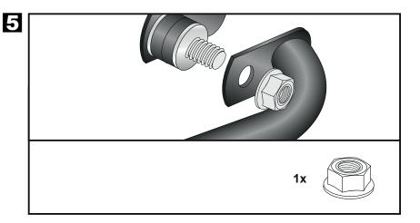
Montage des Motorschutzbügels links oben:
