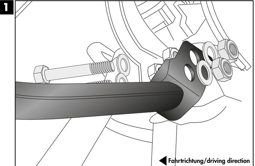
**Befestigung der Tankschutzbügel vorne:**
