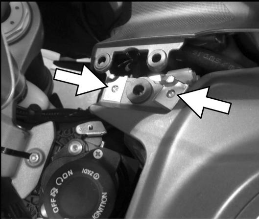
Nun die Schrauben der Tankbefestigung vorne, seitlich und hinten (Abb.5/6) entfernen und den Tank samt oberer lackierter Tankverkleidung nach hinten ziehen. Gegebenenfalls die Kraftstoffhähne unterhalb des Tanks R+L zudrehen und die Schläuche abziehen.
