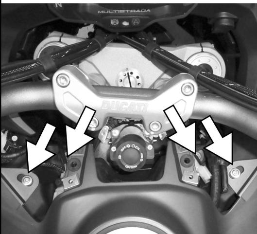
Die seitlichen Tankverkleidung demontieren, hierfür müssen die Schrauben entfernt werden (Abb.4).
