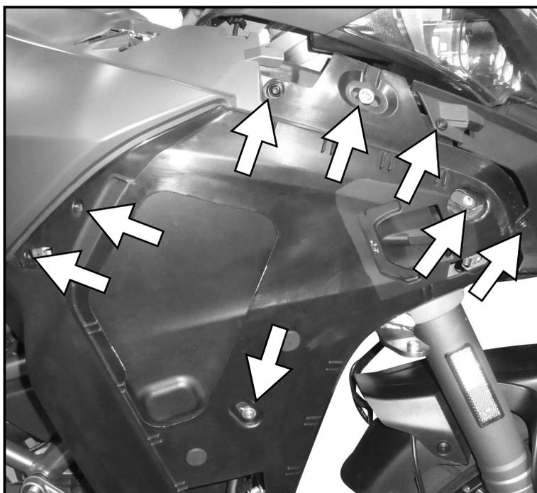
Nun die Schrauben der Tankbefestigung vorne, seitlich und hinten (Abb.5/6) entfernen und den Tank samt oberer lackierter Tankverkleidung nach hinten ziehen. Gegebenenfalls die Kraftstoffhähne unterhalb des Tanks R+L zudrehen und die Schläuche abziehen.
