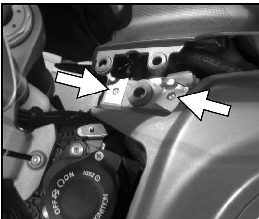
Die seitlichen Tankverkleidung demontieren, hierfür müssen die Schrauben entfernt werden (Abb.4).
