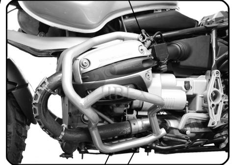
Schraube entfernen und Sturzbügel montieren
