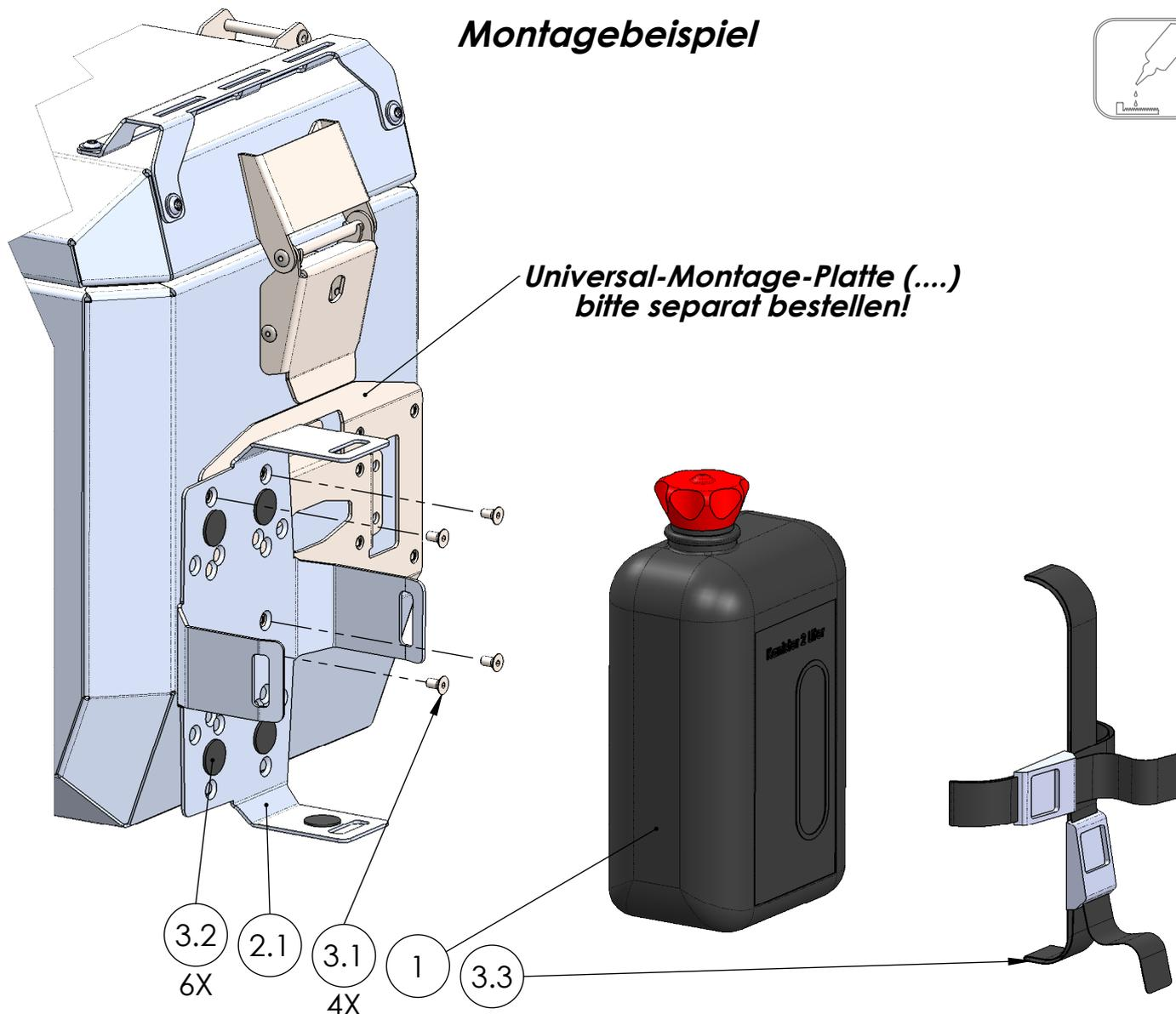
**Die Montage des Halterset's ist in mehreren Lagen und Kombinationen an der Universal-Montage-Platte möglich!
