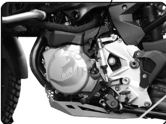
Schraube demontieren und Verkleidung lösen
