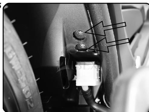
Montieren Sie nun den Halter (Pos.1.3) wie in der Abbildung 8 dargestellt. Verwenden Sie dazu die Distanzhülse (Pos.1.11), die U-Scheiben (Pos.1.6) und die Schrauben (Pos.1.7). Die Distanzhülsen (Pos.1.11) werden zwischen den Anschraubpunkten (Abb.6) des Motorrades
