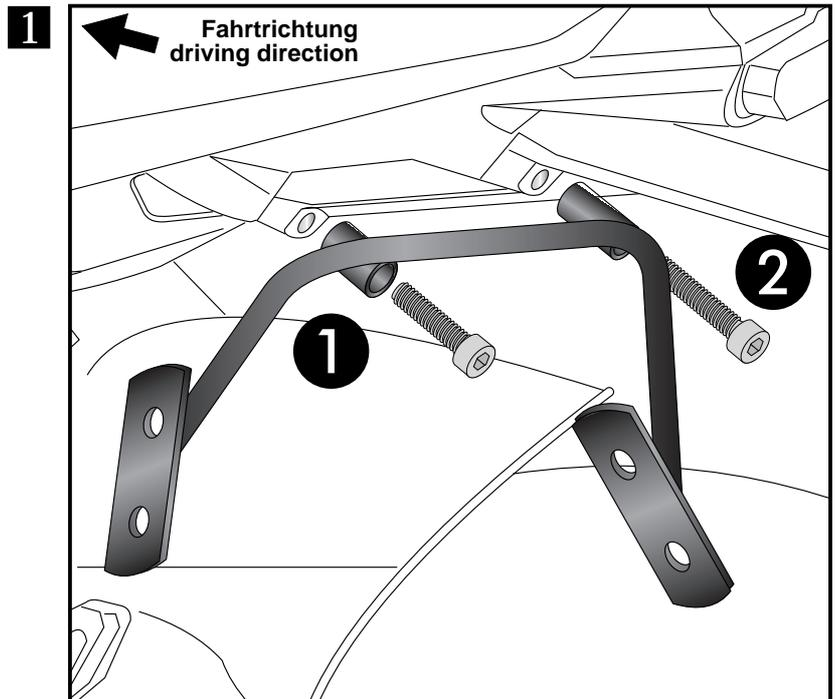
In Kombination mit dem Minirack werden vorne die Zylinderschrauben M6x65 und hinten die Zylinderschrauben M6x75 verwendet.
