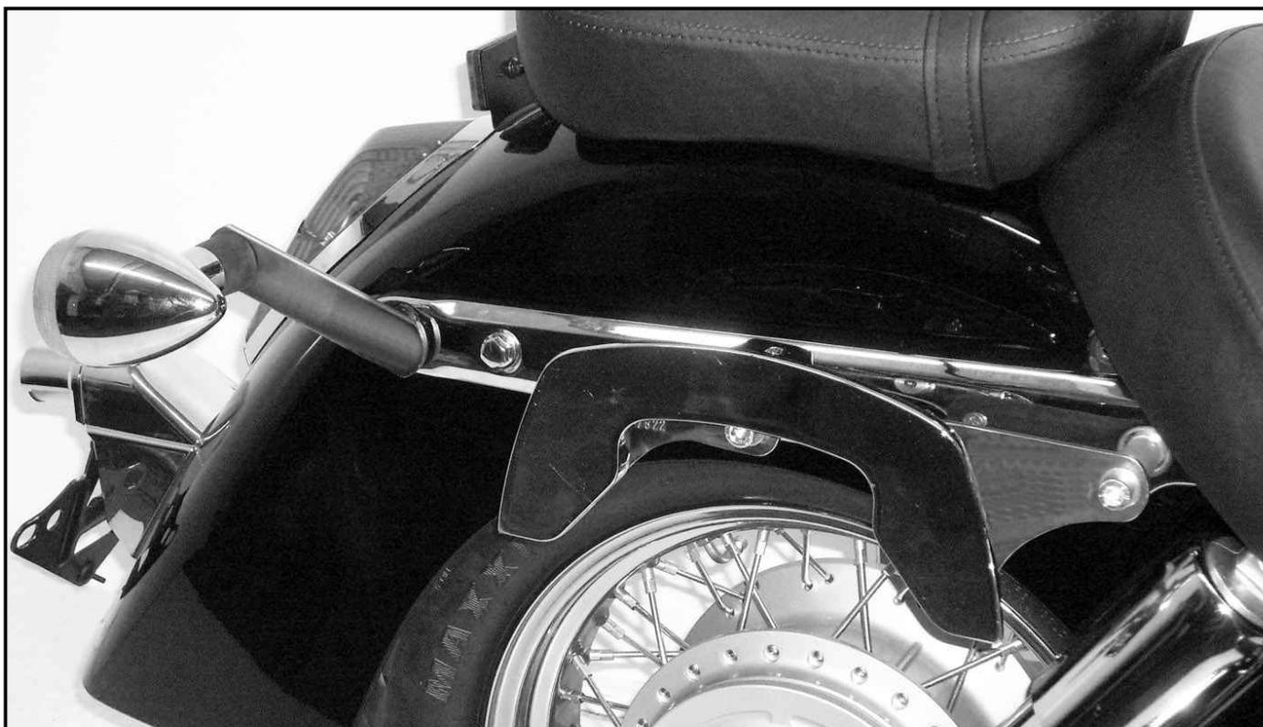
**Ziehen sie alle zugänglichen Schrauben zuerst nur locker an. Nachdem alles montiert ist, werden die Schrauben dann auf das entsprechende Anzugsmoment festgezogen.**
