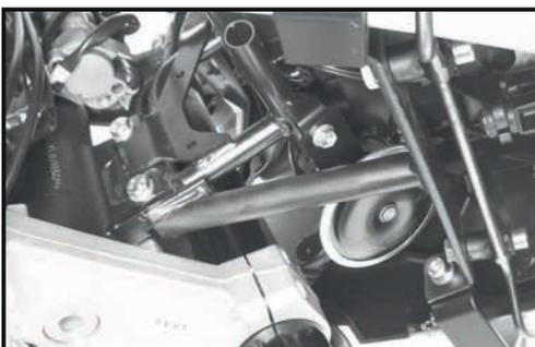
Das Lampengitter wird vorne auf dem Halteadapter befestigt. HINWEIS: die 4 weiteren U-Scheiben  $\varnothing 8,4$  sind für die Montage des Lampengitters vorgesehen.
