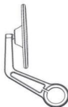
Nach dem Ausrichten des Spiegels wird die M5 Klemmschraube im Arm mit einem Drehmoment von **4 Nm** angezogen.
