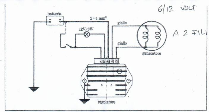
Esempio d'inserzione dei regolatori «a ponte» dotati di faston per lampadina segnalatrice di carica; 434.36.6200/434.36.9200
