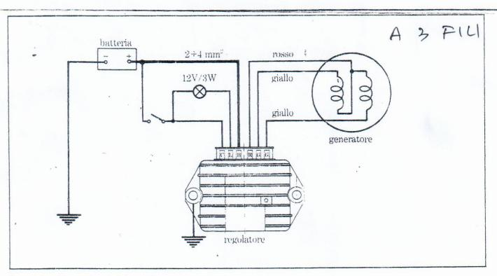
Esempio d'inserzione dei regolatori «controfase» dotati di faston per lampadina segnalatrice di carica: 434.35.4200/434.35.5200 434.35.8200/434.35.9200
