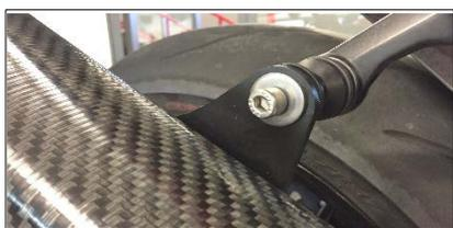
**ITA** Fissare la staffa di supporto al telaio della moto, usando il distanziale in alluminio nero, la vite, le rondelle e il dado in dotazione.
