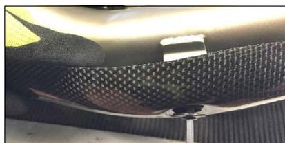
**ITA** Avvitare il paracalore alle staffe del corpo finale utilizzando le viti in dotazione
